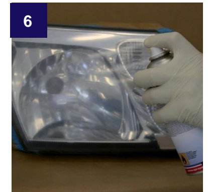
6 Peitä lamppukotelo ja viereiset osat. Ruiskuta Spray Max eristepohjamaalia koko lasille (15µ).
